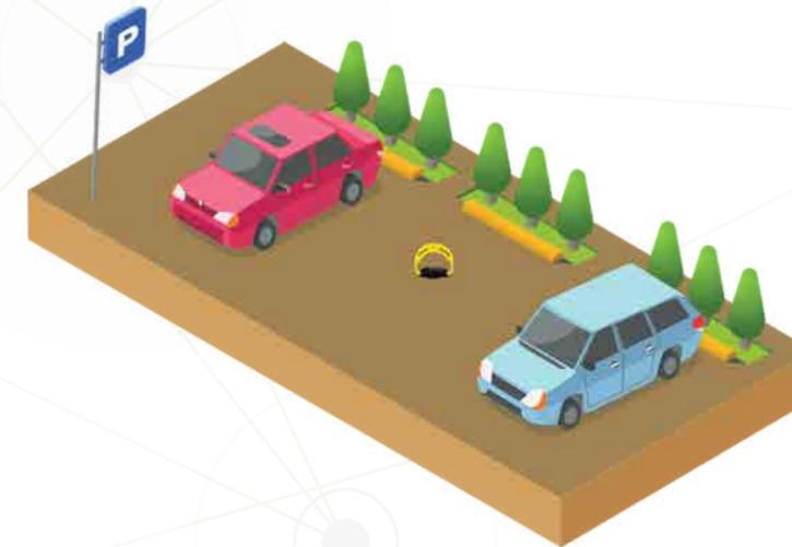
Para una mejor control el Plock 1 es un dispositivo de control de espacios de estacionamiento, el cual no permite que los conductores se estacionen en un lugar de estacionamiento específico a menos que el vehículo tenga la autoridad para tener acceso al estacionamiento. El brazo de Plock 1 puede girar hacia adelante y hacia atrás cuando la cerradura de estacionamiento recibe señales del sensor.
